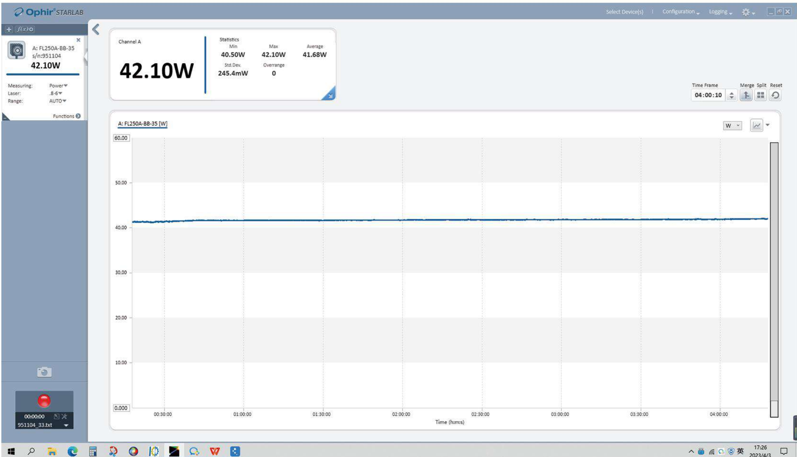
* 紫外皮秒高功率RMS功率稳定性测试结果
